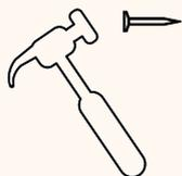
Verifique la resistencia del sustrato (firme), rayando sobre diferentes partes de la superficie del mismo. Si se desmorona fácilmente deberá escarificar o raspar y aplicarse de nuevo, de manera que la superficie sea más resistente. Con esto se eliminará la posibilidad de que se presente el desprendimiento de losetas.
